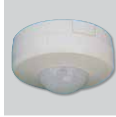
CPFL-S / CPFL-E Varlık dedektörü. Tavana yerleştirilerek insan vücutlarının hareketinden kaynaklarının kızılötesi ışınları algılayarak 360° açıda varlıklarını sezebilir. Güç kaynağı: 1-230 V.
