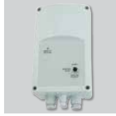
VAPZ Elektronik monofaze regülatör. Fan hızını basit bir kontak (varlık dedektörü) veya 0-10V / 4-20 mA analog giriş (CO2 veya nem ölçer) ile ayarlar.
