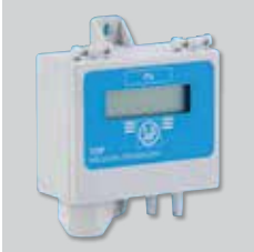
TDP-S / TDP-D Basınç sensörü. Fan emiş ağzındaki basıncı ölçmenize olanak sağlar. Basınç aralığı: 0-2500 Pa. Çıkış sinyali: 0-10V / 4-20 mA.
